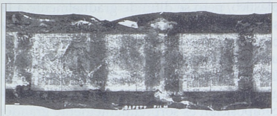
Ilustración 12: Microfilme de acetato de 35mm presentando friabilidad y encogimiento.
