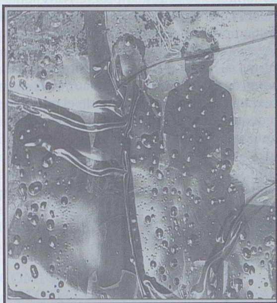
Ilustración 14: Lámina de película de acetato deteriorada presentando estríamiento y protuberancias redondas de plastificante cristalizado bajo la emulsión de gelatina.
