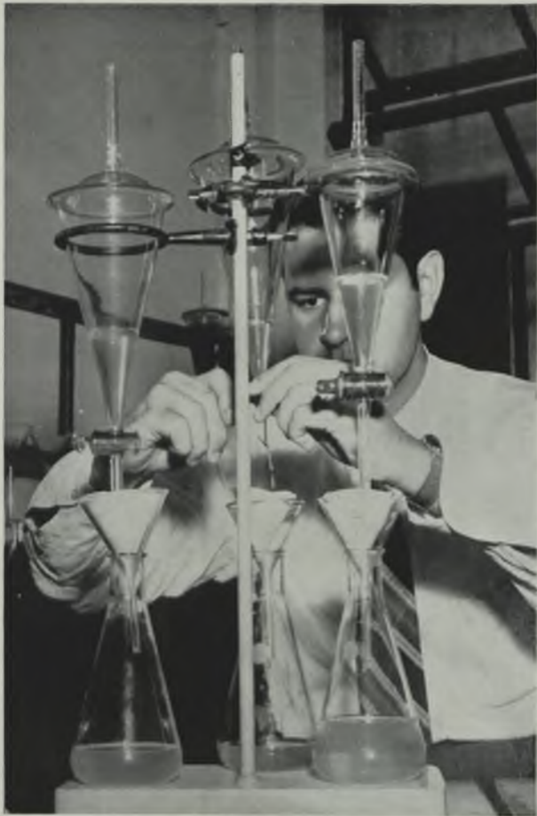
La separación de minerales pesados de los livianos, es un complicado proceso químico realizado en el laboratorio Creole de Geología, Caracas
