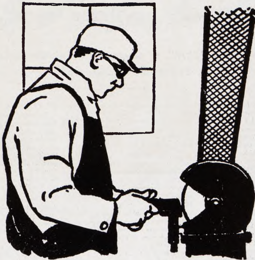
Esta gráfica nos muestra al operario trabajando en una máquina esmeril, debidamente protegida. Desde su base hasta la parte superior ha sido cubierta y sólo una abertura angular se le ha dejado en el lugar preciso, a fin de realizar el trabajo. Además y para mayor seguridad, el operador usa lentes protectores.
