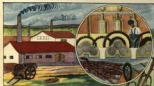
La primera operación de la industrialización de la caña consiste en la trinchado o trituración del pago, para lo cual existen las trocadoras. Cuando salen los fragmentos cortados el jugo o "guapeo". Los tallos expresados se llaman bagazo, y son utilizados como combustible en el proceso de azúcar.
