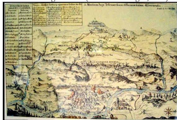
Figura 43. Parte de una impresión en cobre coloreada a mano que muestra a Kongsberg y la zona minera central c. 1700. Se muestran presas, conductos y edificios para ruedas hidráulicas y pozos. A lo largo del río: la quema de carbón, la fundición de plata (entre los dos puentes) y la fundición de hierro. Tomado de https://www.mindat.org/loc-33366.html
