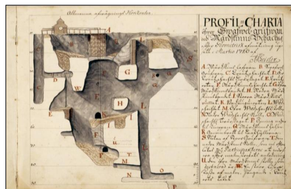
Figura 28. Perfil de una sección de la mina de cobre Falun realizado en 1720, donde se aprecian los túneles y galerías subterráneas. Elaborado por el topógrafo minero Johan Tobias Geisler. Tomado de https://www.arkivcentrumdalarna.se/919.php
