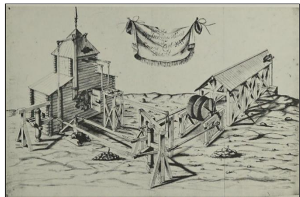
Figura 31. Imagen de uno de los desarrollos mecánicos creados por Christopher Polhem en el Pozo Karl XII de la mina de Falun, conocido como el “Elevador de Polhem”. Las condiciones locales le obligaron a doblar en ángulo recto los balancines entre la timonera y el tambor de enrollamiento. Tomado de Rydberg (1979)
