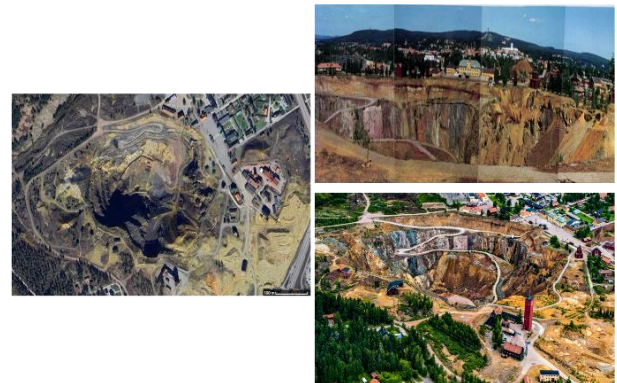
Figura 35. Vista satelital y panorámicas actuales de la mina de Falun con el gran pozo Stora Stöten de aproximadamente 100 metros de profundidad y 350 m de diámetro y los edificios e instalaciones superficiales del acopio minero.
