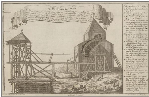
Figura 30. Imagen del libro de Erik Dahlbergh (1625-1703) que ilustra a las máquinas hidráulicas que permitían el bombeo del agua y la acción de todos los mecanismos de producción de cobre en la mina de Falun, las cuales causaron gratas impresiones en Francisco de Miranda por su avanzado desarrollo cuando las detalló en 1787. Tomado de https://suecia.kb.se/suecia/pdf/20/8530320.pdf
